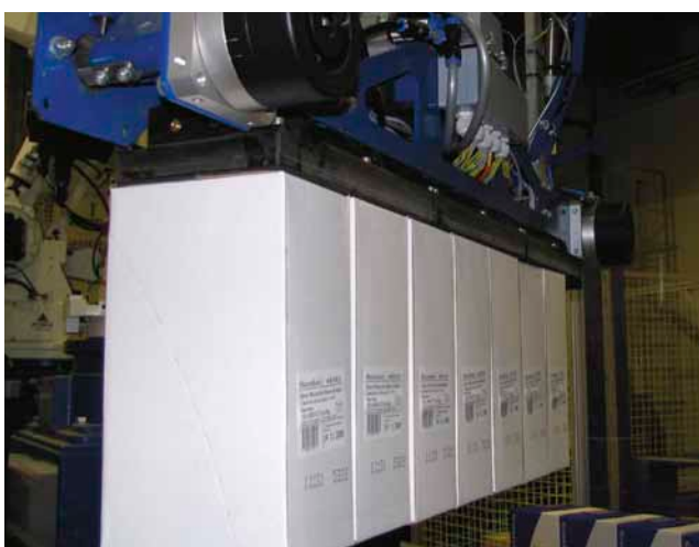
Kasseløft med robot som er påmonteret VUSS vakuum system.
