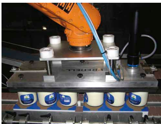
VUSS vakuum systemet håndterer effektivt de 85° varme og fugtige glas.
